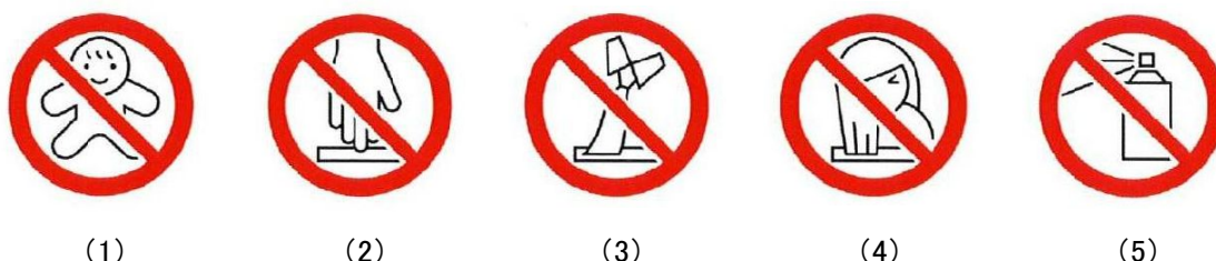
図 5.1.1 警告表示に使用する禁止図記号
